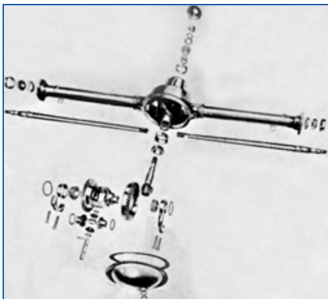
شکل ۹-۴- نوع یک‌پارچه این دیفرانسیل ساده است و تنظیمات پس از نصب کردن انجام می‌شود.
