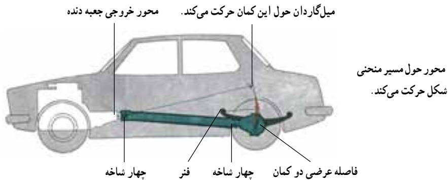
شکل ۳-۴ حرکت میل‌گاردان و محور عقب در جاده
