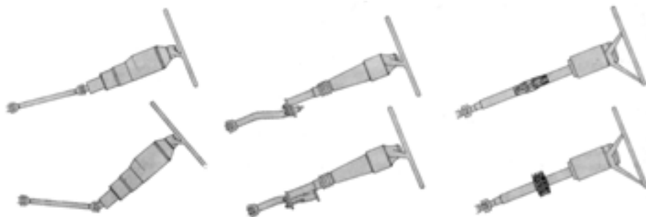
شکل ۳-۵-۳- b- فرمان‌هایی که در موقع وارد آمدن ضربه در هم فرو می‌روند.
