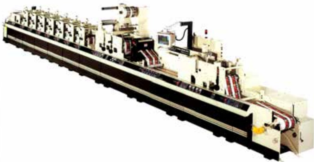
شکل ۱-۵۵- دستگاه چاپ برجسب گالوس Galluss Res 330
