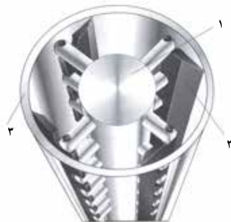
۱- محور چرخنده ۲- تیغه ۳- بدنه استوانه
