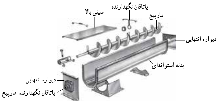
شکل ۱۴-۱ اجزای نقاله مارپیچی
