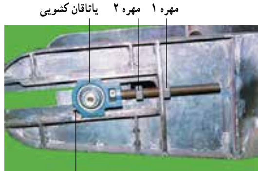
شکل ۱۱-۱- تنظیم کننده کشیدگی تسمه نقاله
