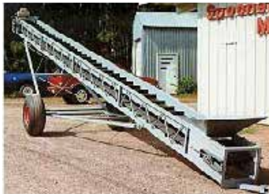
شکل ۳۰-۱- نقاله زنجیری شیبدار
