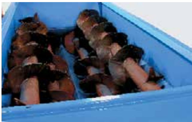
شکل ۴-۵ - ماریپیج‌های مخلوط‌کن در مخزن مواد
