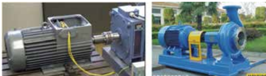
شکل ۴-۲۸ سیستم انتقال قدرت مستقیم
