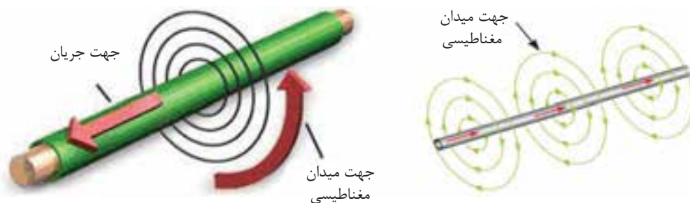
شکل ۴-۴ خاصیت مغناطیسی اطراف سیم حامل جریان
