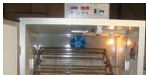
الف) هواکش دستگاه جوجه‌کشی
