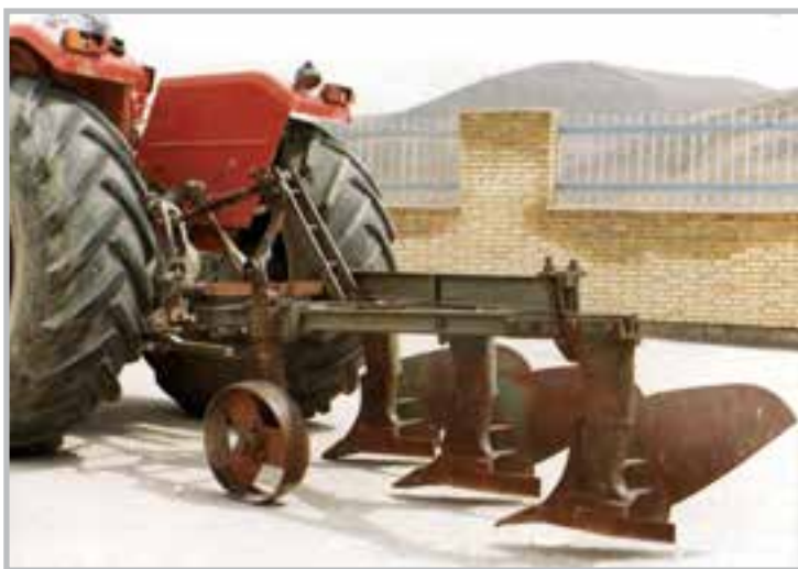
شکل ۲۷-۱- اندازه فاصله انتهای کفش آخرین خیش با زمین
