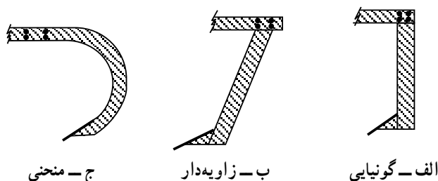
شکل ۵۲-۱- انواع ساق در گاو آهنهای زیرشکن
