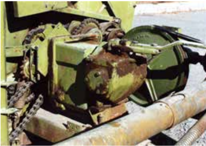
شکل ۸-۷- جعبه دنده‌ها و اجزای انتقال قدرت
