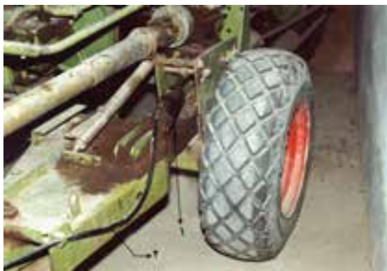
شکل ۱۱-۷- جک هیدرولیکی و شیلنگ مربوط در ذرت خردکن علوفه ای
