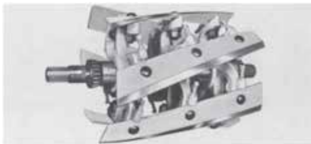
شکل ۴-۷- استوانه خردکن و تیغه‌های آن
