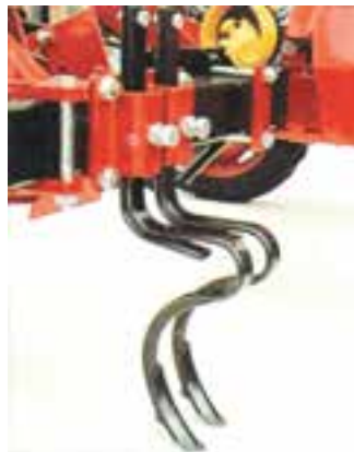
شکل ۱۰-۷- دندانه‌های پاک‌کننده اثر چرخ
