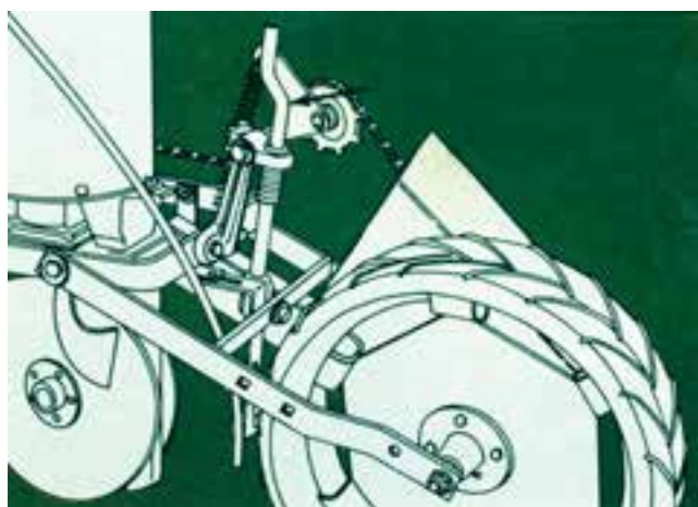
شکل ۱۷-۷- دسته تنظیم عمق پس از خواباندن ضامن با چرخاندن دسته، چرخ فشار بالا و پایین رفته و عمق کاشت را تغییر می‌دهد.
