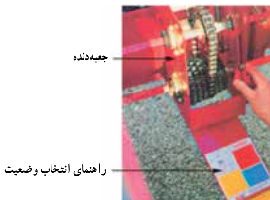
شکل ۷-۱۵- با تغییر وضعیت زنجیر روی دنده‌ها فاصله بذرها تنظیم می‌شود.
