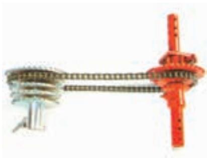
شکل ۸-۱۱ — زنجیر و چرخ زنجیر سیستم محرک موزّع
