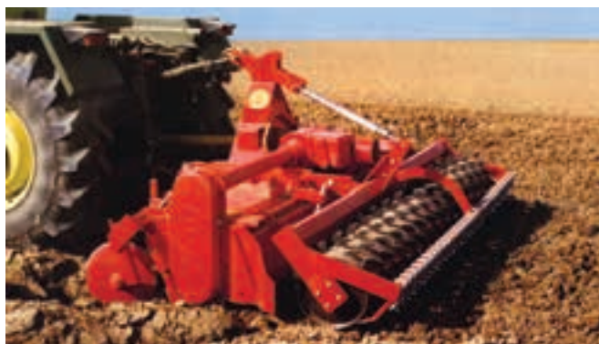
شکل ۱۴-۸ - ماشین مرکب خاک ورزی شامل گاوآهن دوار و غلتک
