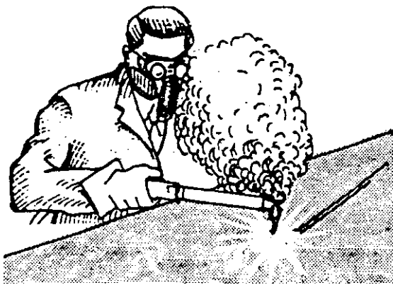
شکل ۳۰-۱- در موقع برشکاری روی سطوح گالوانیزه و رنگ شده از ماسک تنفسی استفاده کنید.
