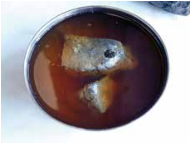
شکل ۱۲-۲- نگهداری کاربید در زیر نفت
