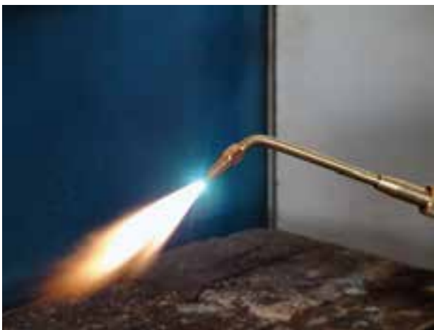
شکل ۲-۳- شعله‌ی سوختن گاز استیلن با اکسیژن
