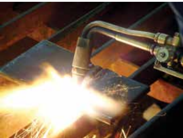
شکل ۲-۶- برشکاری با گاز
