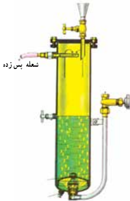
شکل ۲-۴۲- هنگامی که شعله پس می‌زند
