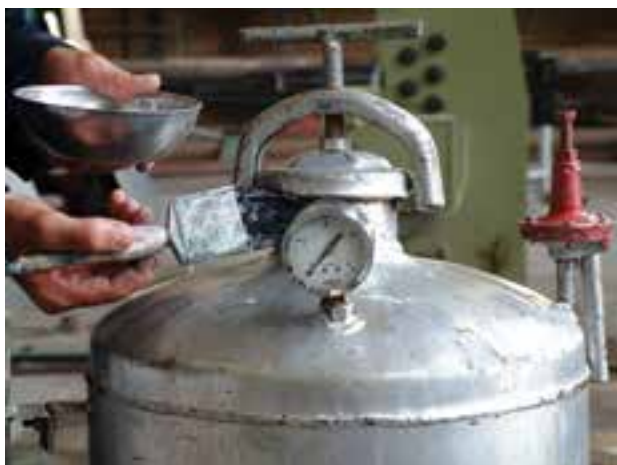
شکل ۲-۳۸- کنترل نشتی گاز
