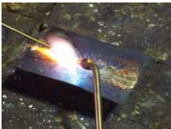
شکل ۴-۷- ایجاد گاز در اطراف محل لحیم کاری
