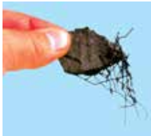
شکل ۱-۱- آهنربای طبیعی براده‌های آهن را جذب می‌کند.
