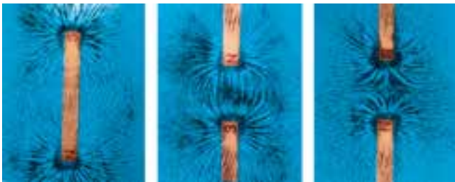
شکل ۱-۲- توزیع براده‌های آهن در یک آهنربای میله‌ای
