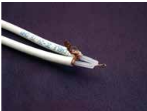
شکل ۱-۶۳- سیم کابل نباید دو تکه باشد.
