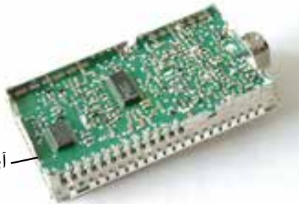
شکل ۲-۵۳- محل آی سی ۹۰۱۰ در روی بُرد
