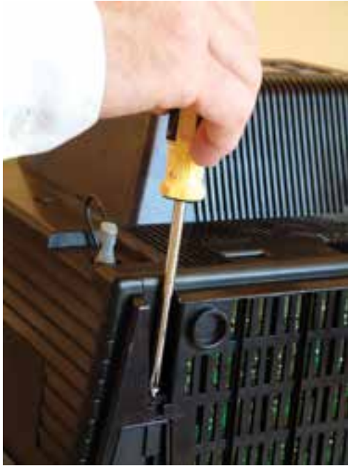
شکل ۲-۴۲- نحوه‌ی باز کردن قاب پشت تلویزیون
