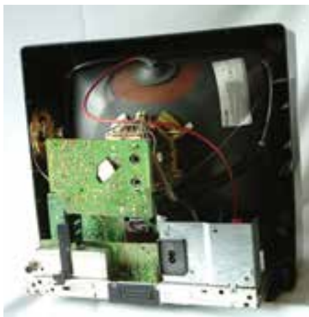
شکل ۱۹۰-۲- تلویزیون بدون قاب پشت
