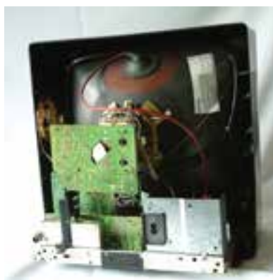
شکل ۱۶۶-۲- تلویزیون بدون قاب پشت
