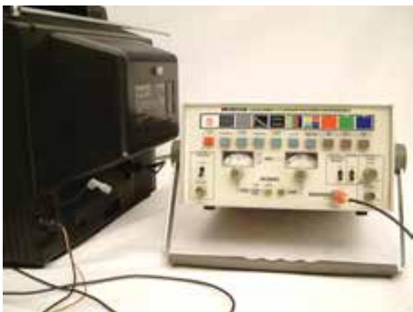
شکل ۱۷-۲ اتصال پترن ژنراتور به تلویزیون
