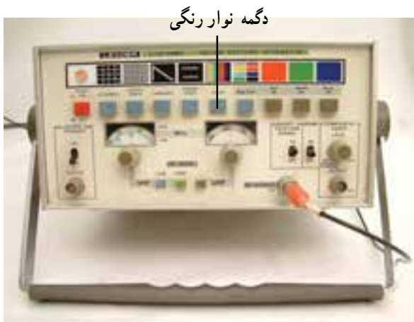
شکل ۲-۱۷۳- دگمه نوار رنگی روی پترن ژنراتور
