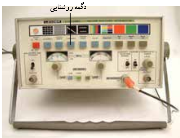
شکل ۱۷-۲ دگمه Luminun در روی پترن ژنراتور
