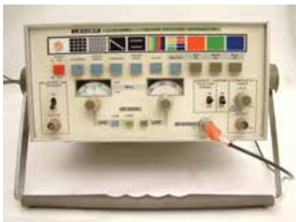
شکل ۱۶۳-۲- نمونه‌ای از پترن ژنراتور رنگی
