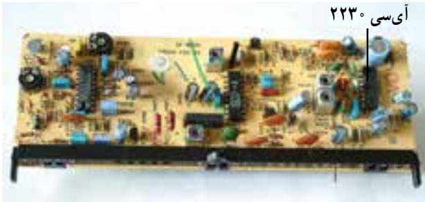
شکل ۳-۶ محل نصب آی سی ۲۲۳۰ روی بُرد
