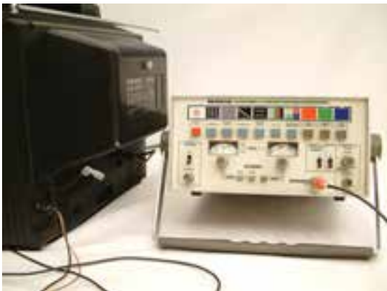
شکل ۳-۳۹- اتصال پترن ژنراتور به تلویزیون
