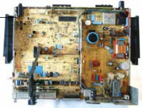
شکل ۲۶-۳- محل نصب آی سی ۳۶۵ در برد اصلی
