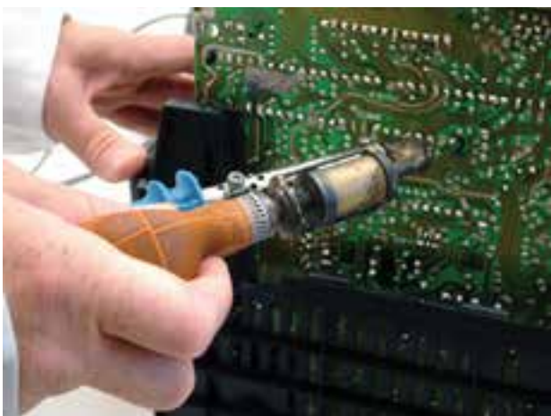
شکل ۴-۸۳- جدا کردن پایه قطعه از روی برد باید با قلع کش انجام گیرد.
