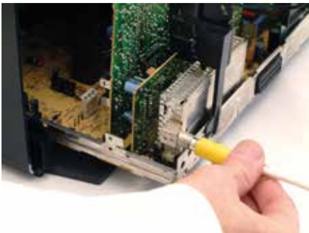
شکل ۴-۸۱- در اتصال سیم رابط به تیونر، به دستگاه فشار زیاد وارد نکنید.
