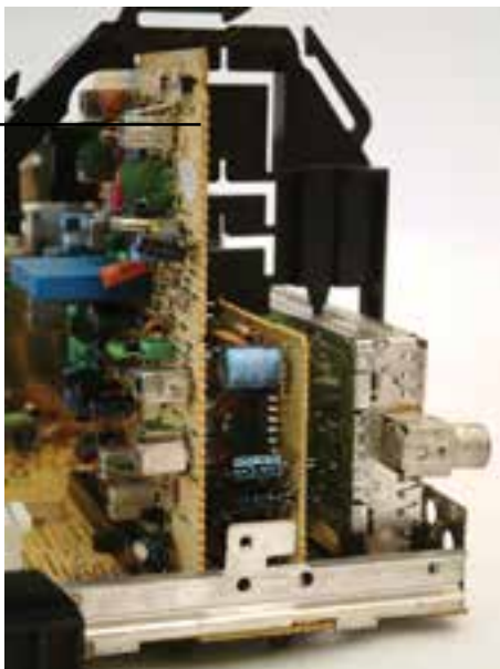
شکل ۲۰۳-۴ - مدولی که باید تعویض شود.
