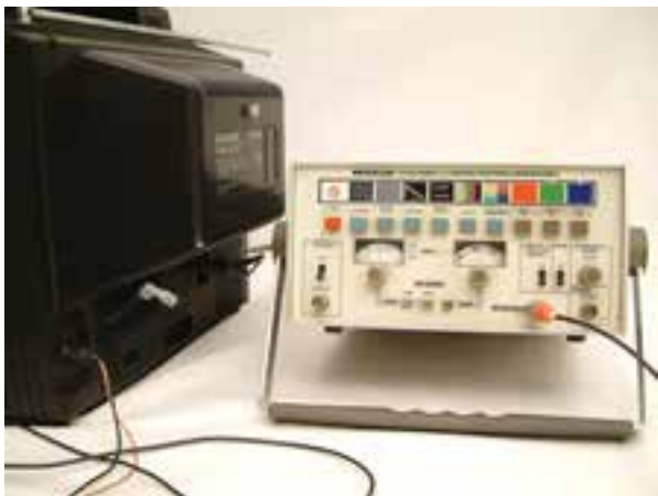
شکل ۴-۱۹۲ - اتصال پترن ژنراتور به تلویزیون
