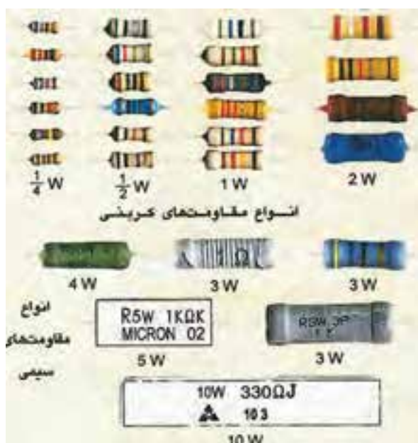
شکل ۱۷-۶- استانداردهای توان در مقاومت ها
