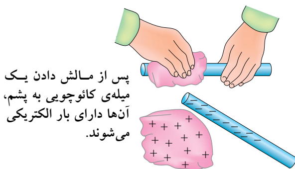
شکل ۱۸-۳- الکتریسته مالشی (اثر تریبو الکتریک)
