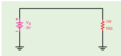
شکل ۱۶-۶ بررسی جریانی مصرف کننده براساس توان مجاز
