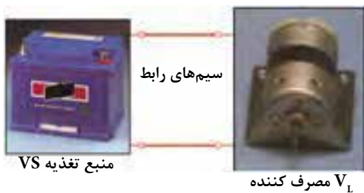
شکل ۵-۹۶ افت ولتاژ بین مولد و مصرف کننده
