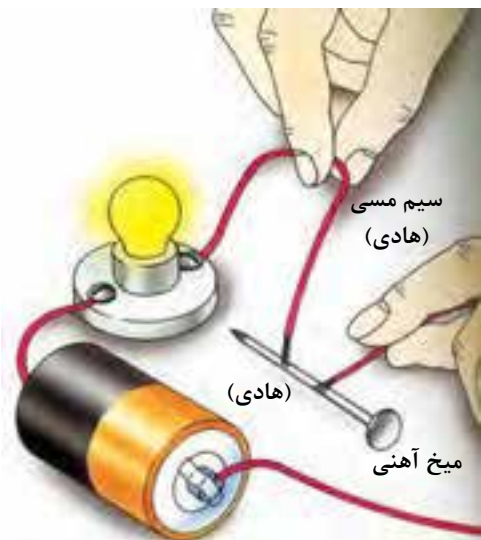
شکل ۲-۳- برقراری جریان الکتریکی در هادی‌ها
