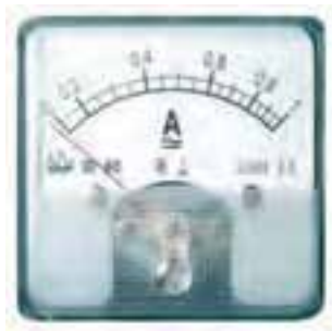
شکل ۹-۳- شکل ظاهری یک نمونه آمپر متر
