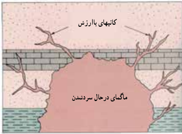
شکل ۱۳-۱۰- نهشته های گرمایی به صورت رگه در اطراف اتاقک ماگمایی
