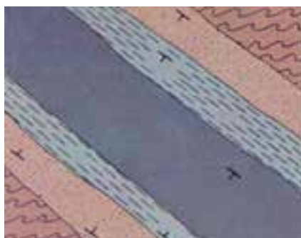
شکل ۱۳-۹- نقشه زمین شناسی یک ناودیس با محور افقی
