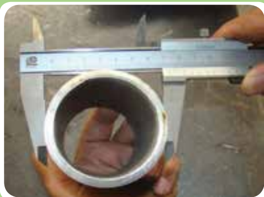
اندازه‌گیری قطر خارجی لوله توسط کولیس
