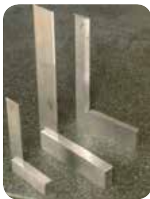
استفاده از گونیا ۹۰ درجه برای کنترل زاویه های قائم
