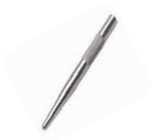
سنبه نشان برای نشانه گذاری روی قطعات فلزی
