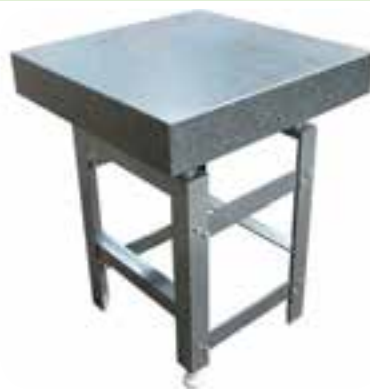
میز خط کشی یا صفحه صافی برای اندازه گیری و خط کشی قطعات استفاده می شود.
