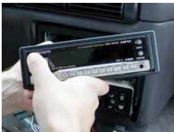
شکل ۴-۲۸- خارج نمودن رادیوپخش از داخل قاب کنسولی
