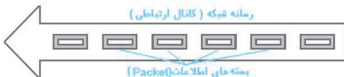
شکل (۲-۷) ارسال Packet اطلاعاتی در شبکه‌های Packet Switching
