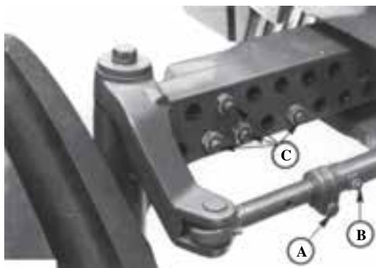
شکل ۱-۱۴ A- پیچ بست خارجی میل مهار فرمان B- پیچ بست داخلی میل مهار فرمان C- پیچ‌های محور
