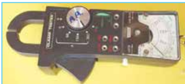
شکل ۵۸- نمای ظاهری یک آمپرمتر انبری
