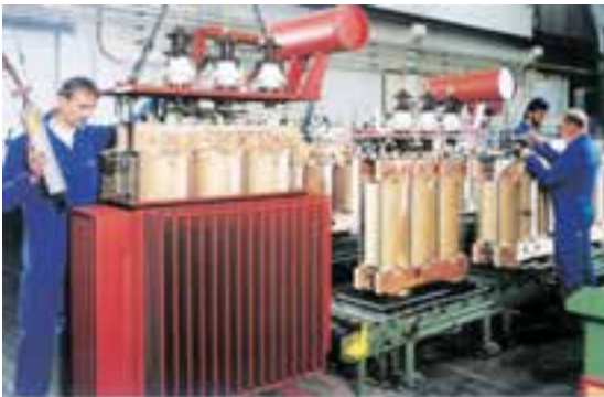
شکل ۱۵- نحوه قرار دادن هسته و سیم پیچها در داخل مخزن روغن
