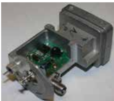
شکل ۲۹-۲ LNB و مدار داخل آن
