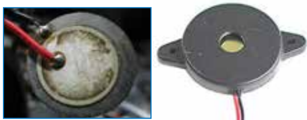
شکل ۹-۲۸- ساختمان داخلی و شکل ظاهری صفحه حساس پیزوالکتریک
