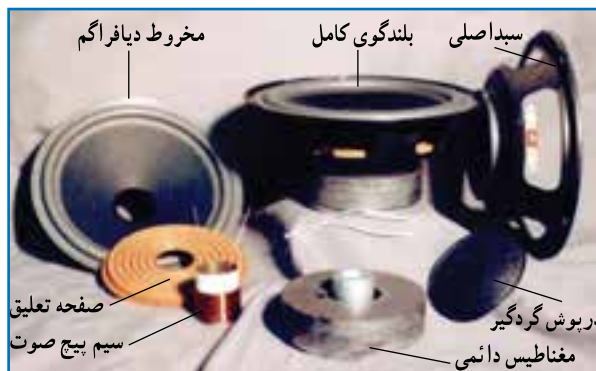
شکل ۹-۲۶ - یک نمونه بلندگو و اجزای باز شده آن
