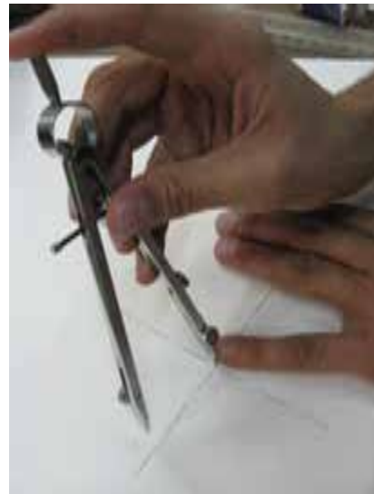
ب) طریقه‌ی رسم دایره به کمک پرگار
