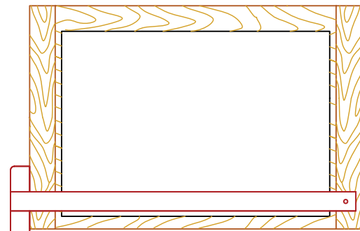
(ف) قراردادن خط‌کش تی و کاغذ روی تخته
