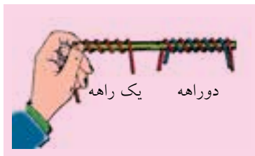
(ب) تشکیل پیچ یک‌راهه و دوراهه
