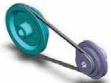
(ب) مکانیزم چرخ‌تسمه
