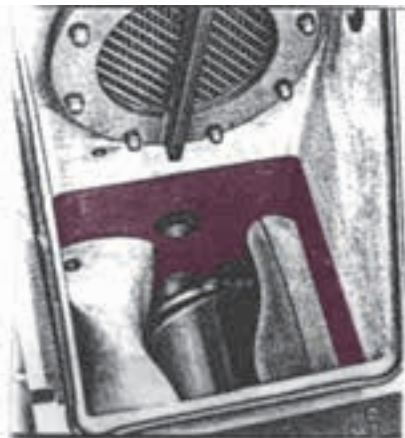
(ج) محفظه‌ی خلأ و صفحه‌ی مشبک برای رشته رشته کردن گل، به منظور هوازدایی
