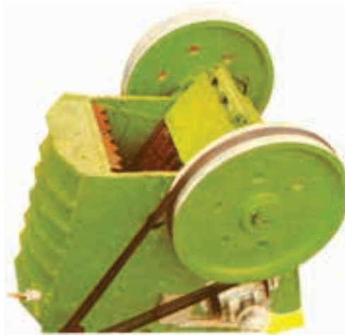
شکل ۱-۳- یک سنگ شکن فکی
