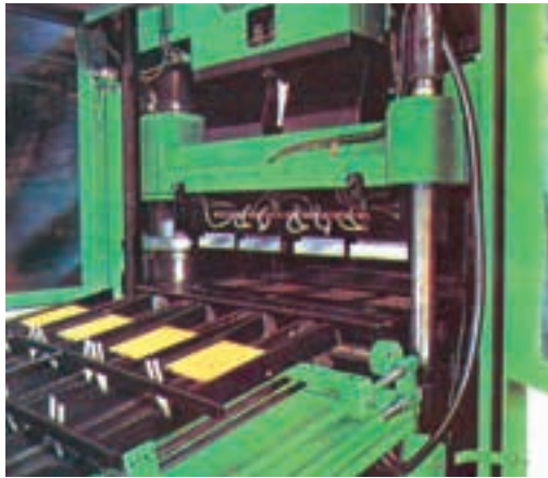
ج) وسیله تخلیه کاشی پرس شده از روی قالب شکل ۴-۱- تصاویری از اجزاء دستگاه پرس
