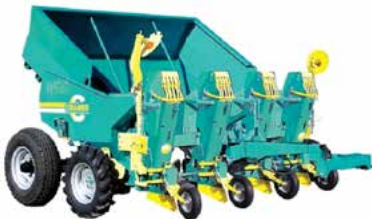
شکل ۱۶-۲- یک نوع ماشین سیب‌زمینی کار خودکار با سیستم جبران‌کننده
