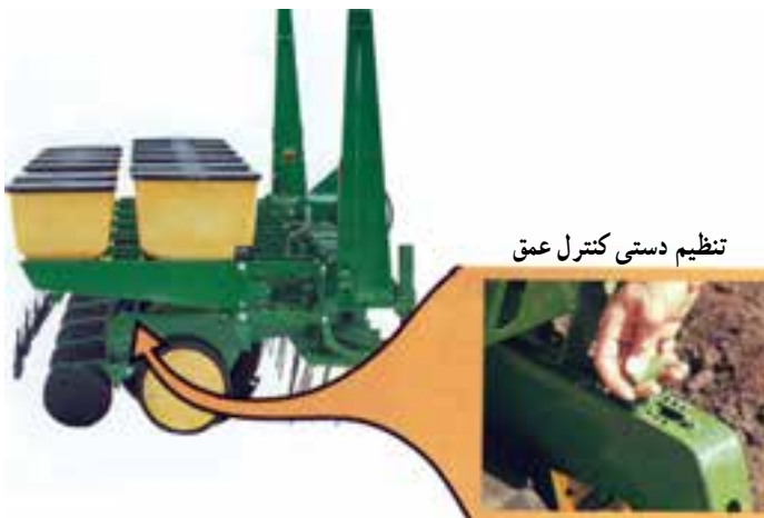
شکل ۸-۲- تنظیم عمق شیار بازکن‌ها با استفاده از میله مجهز به فتر در اشکال مختلف در ردیف کارها
