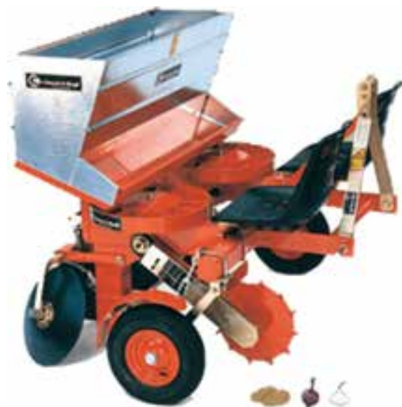
شکل ۱۵-۲- سیب‌زمینی کار نیمه خودکار
