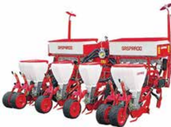
الف - ردیف کار پنوماتیکی
