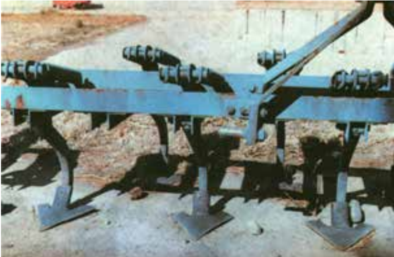
شکل ۵-۶- کولتیواتور فندار با تیغه پنجه‌غازی
