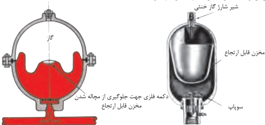
شکل ۴-۱-۱- آکومولاتور گازی نوع دیافراگمی
