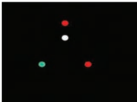
شکل ۱۰-۴- هواپیمای آب نشین و چراغ‌های راه دریانوردی آن
