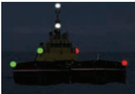
شکل ۲۰-۴- چراغ‌های شناور یدک کننده و یدک شونده که با هم یک واحد مرکب را تشکیل می‌دهند.
