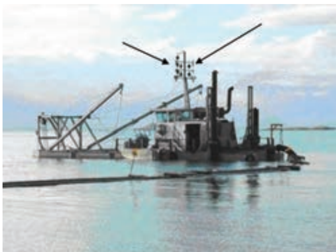
شکل ۳۹-۴- علائم بصری کشتی دارای محدودیت مانور با تعیین سمت محدودیت مانور
