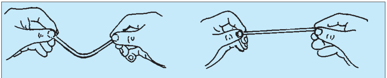
لوله را به شکل دلخواه خم کنید.
