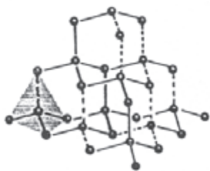
شکل ۴-۱۴- آرایش اتم‌های کربن در الماس. هر اتم کربن در مرکز یک چهاروجهی قرار دارد. الماس سخت‌ترین ماده شناخته شده است.
