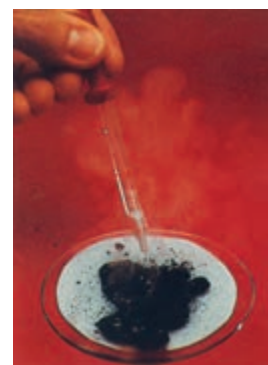
شکل ۱۰-۷- محلول هیدروژن پروکسید در مجاورت منگنز دیوکسید به طور شدید تجزیه می شود.
