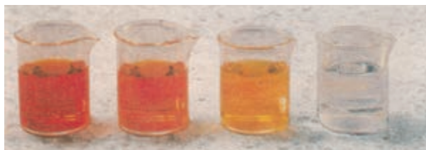
شکل ۷-۲- غلظت Br_2 در ظرف واکنش با گذشت زمان، کاهش می‌یابد (از چپ به راست) در نتیجه از شدت رنگ محلول به تدریج کاسته می‌شود.
