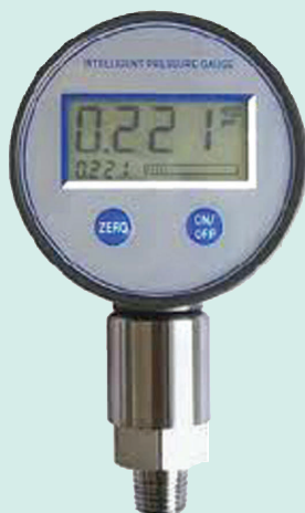
شکل ۳-۱۴- فشارسنج بوردن دیجیتالی
