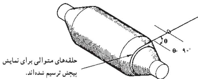
شکل ۱-۱۳- بسته‌ی نخ با پیچش تقریباً موازی با دو سر شیب‌دار
