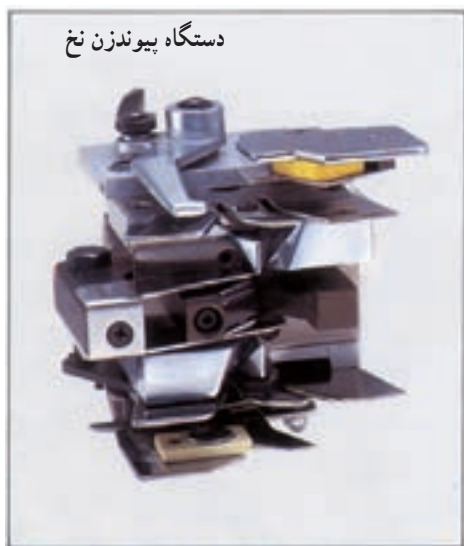
شکل ۱-۱۹- پیوند نخ در ماشین بوبین پیچی
