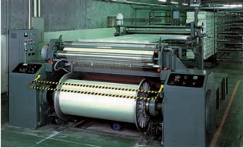
شکل ۲-۵ - دستگاه چله پیچی مستقیم
