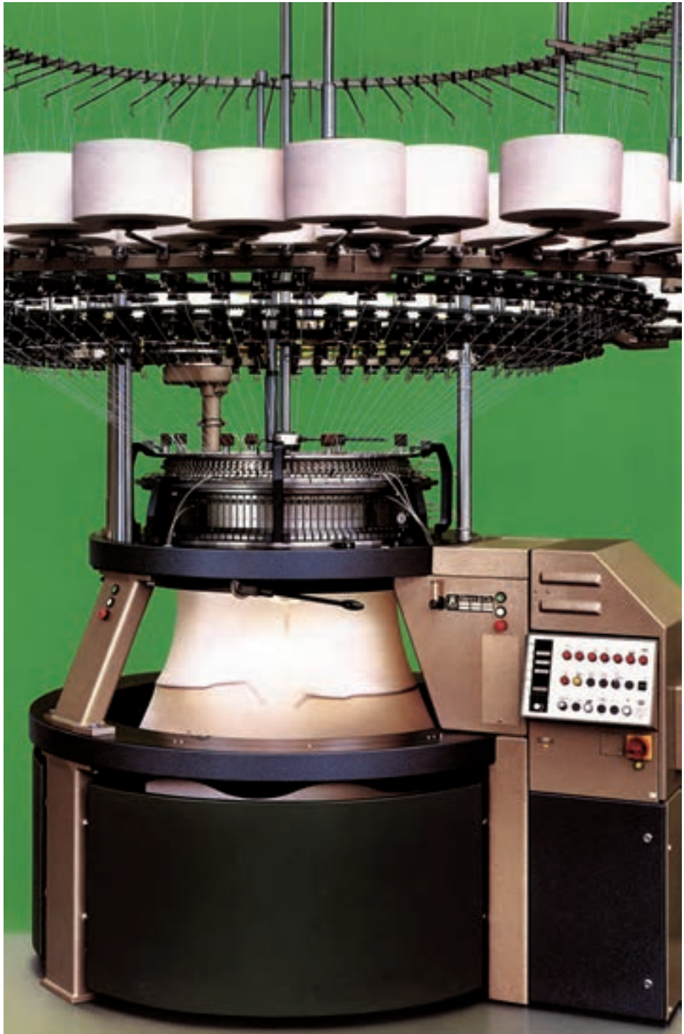
شکل ۱۰-۸ - نمای ظاهری ماشین گردباف یک سیلندر مجهز به سوزن زبان‌دار
