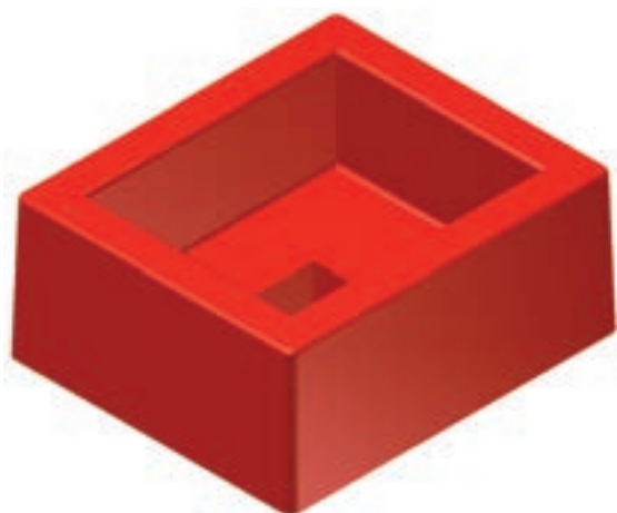
شکل ۷-۱- مدل با ماهیچه سرخود
