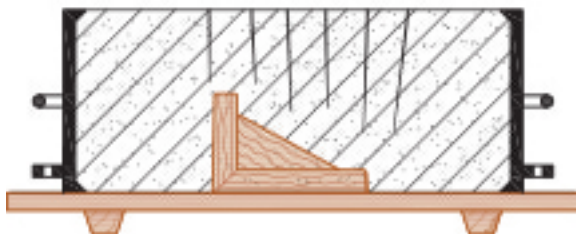
شکل ۶-۱۰ - مرحله قالب‌گیری تای زیرین
