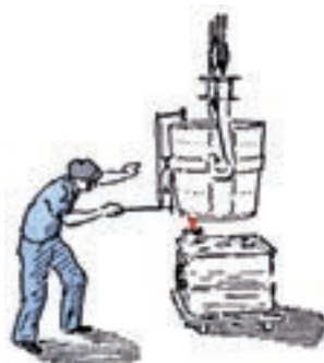
شکل ۸-۲۷ – بارریزی با پاتیل کف ریز
