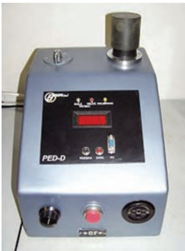
شکل ۱۷-۱- یک نوع دستگاه تعیین قابلیت نفوذ گاز
