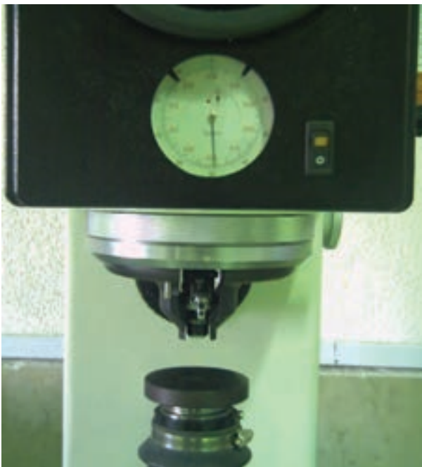
شکل ۱۸-۲- آزمایش سختی راکول
