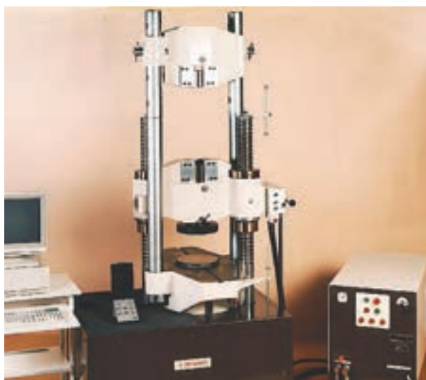
شکل ۱۱-۲- دستگاه آزمایش فشاری و نمونه آزمایش
