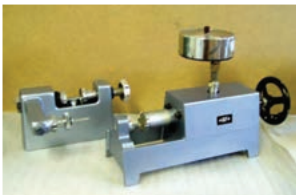
شکل ۹-۱- دستگاه اندازه‌گیری استحکام ماسه
