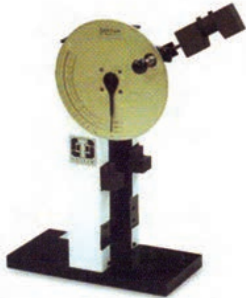
شکل ۲-۲۶- نوعی ماشین آزمایش مقاومت ضربه
