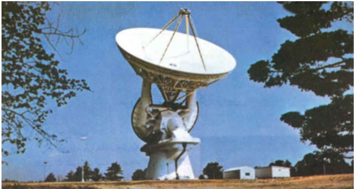
شکل ۳-۲- یک تلسکوپ رادیویی، صفحه‌ی گردان این گیرنده حدود ۴۶ متر قطر دارد و می‌تواند امواج رادیویی دریافت کند.
